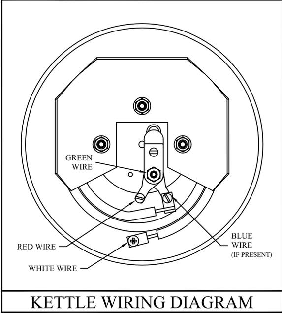
**KETTLE WIRING DIAGRAM**
